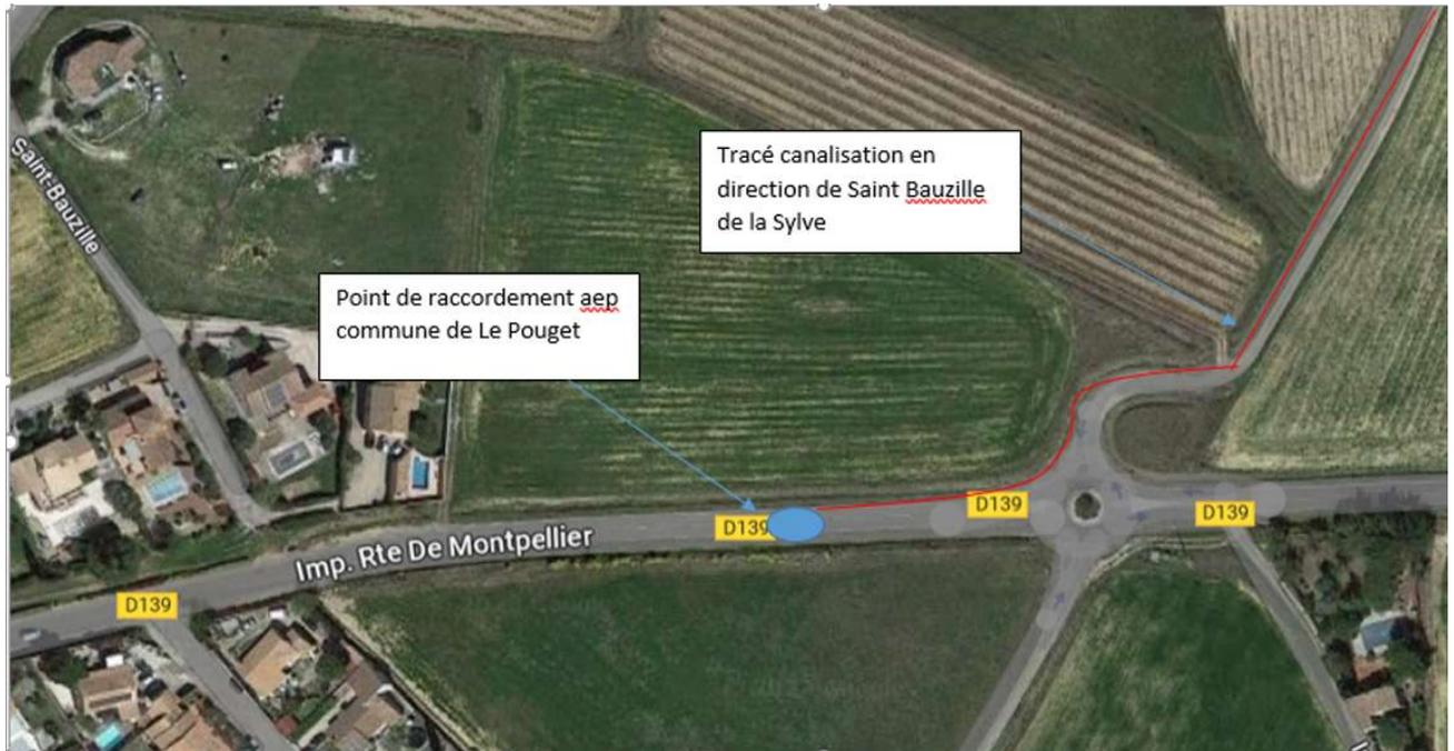
Le raccordement sera réalisé sur une conduite de DN 125 en PVC Pression avec la création d'un ouvrage en Génie civil de 1,2 sur 1,2 mètres.
